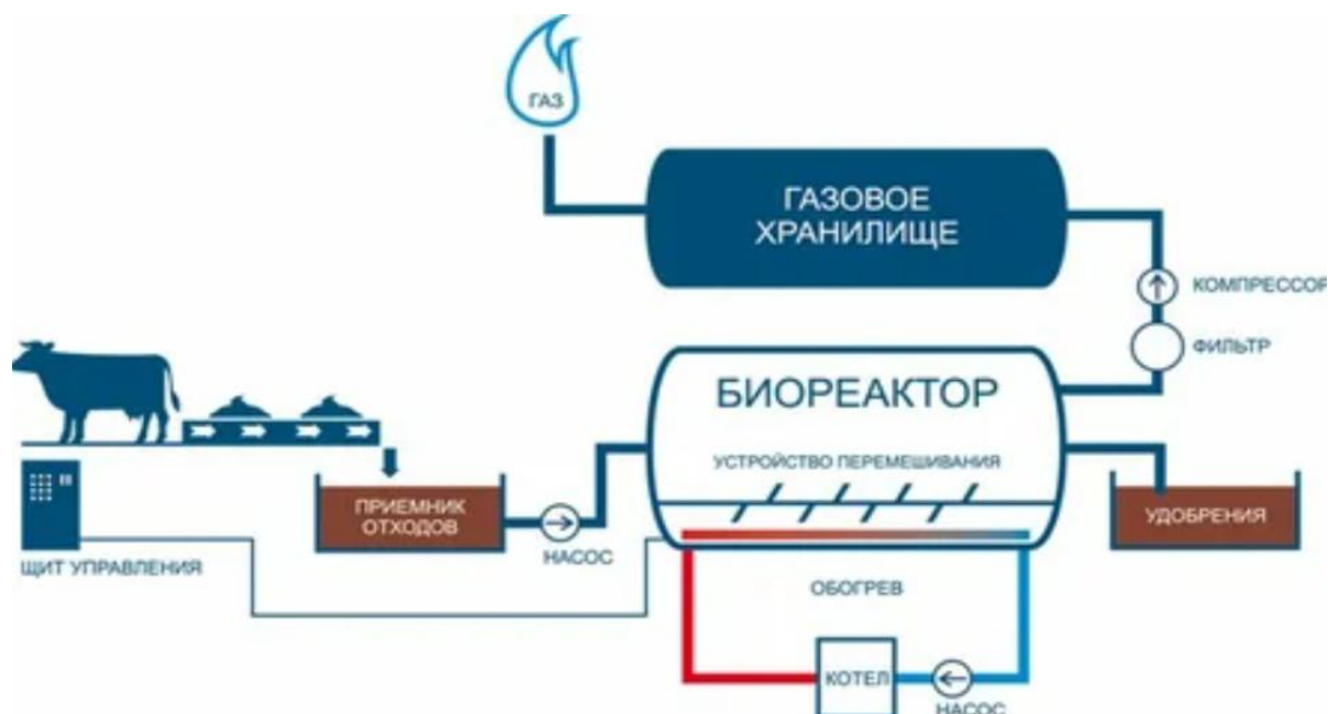
Рисунок 1. Схема биогазовой установки
